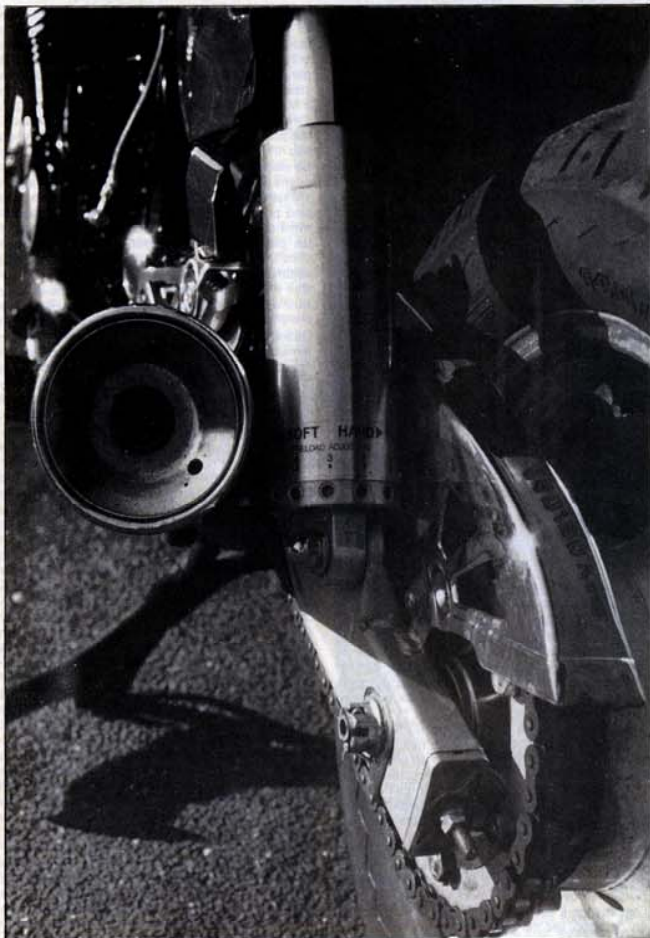
Pour un motif purement esthétique la suspension arrière est constituée de deux combinés oléopneumatiques du type De Carbon. Comme vous devez pouvoir le distinguer sur cette vue, la pré-contrainte du ressort est réglable sur cinq positions.
